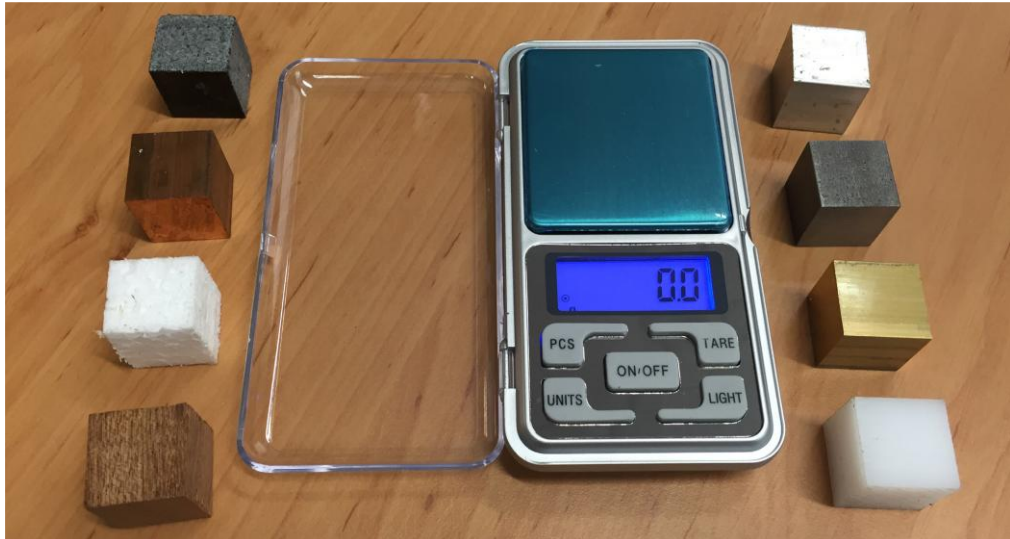
Figure 9 : Installation pour test de masse
