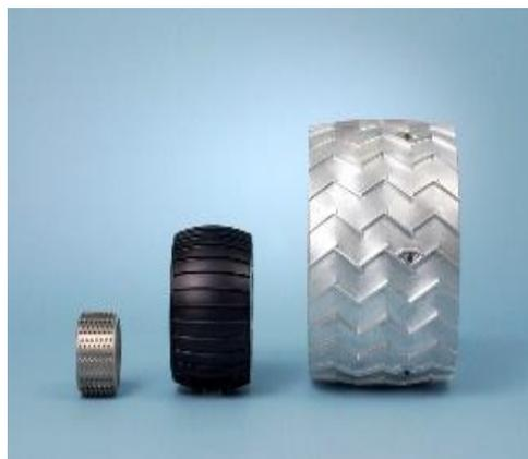
Figure 3 - Les roues des rovers, de gauche à droite : S, S/O, C. Source : WIKIPEDIA
