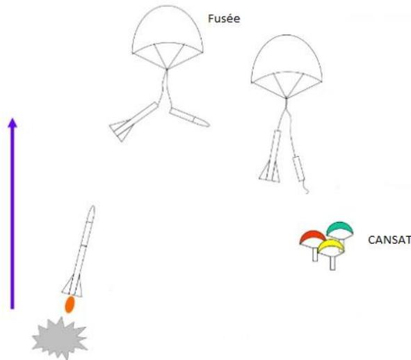
Pendant le vol, la fusée peut atteindre une accélération maximale de 11g dans la direction verticale et une vitesse maximale de 550 km/h.
