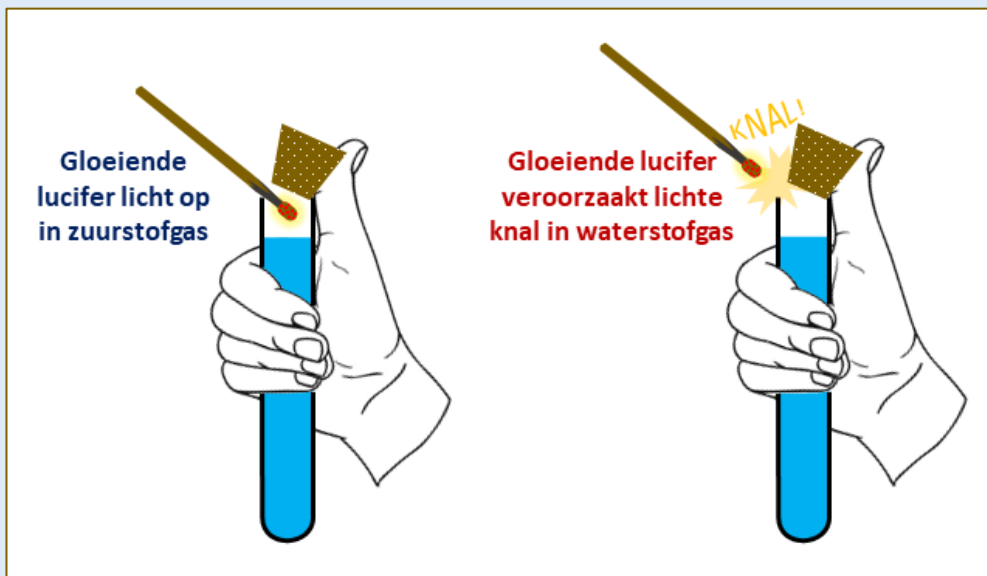
Na splitsing van water: testen of we waterstofgas en zuurstofgas verzameld hebben. Afbeelding: UGENT Volkssterrenwacht Armand Pien.
