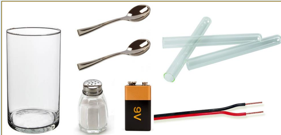
Materialen die nodig zijn om water te splitsen in zuurstofgas en waterstofgas.
