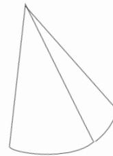
Avec le morceau de papier ainsi obtenu, formez le cône en glissant un des bords obtenus en coupant le rayon sous le second, La forme devrait se rouler sur elle-même et former le cône. Serrez-le jusqu'à ce que le diamètre de la base du cône soit égale à celle du tube, et collez le cône afin qu'il garde sa forme.
