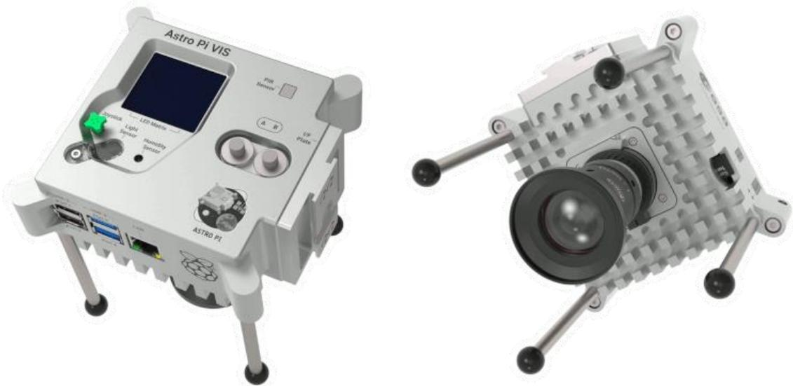
Les AstroPi sont des micro-ordinateurs RaspberryPi muni de toute une série de capteurs:
