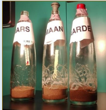
Opstelling van het klasexperiment over het broeikaseffect in atmosferen.
