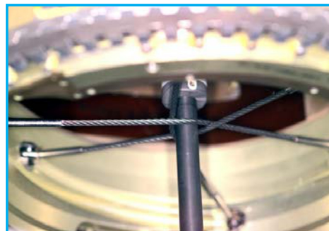
Snares/strikken gesloten rond een pin van een gripper.
