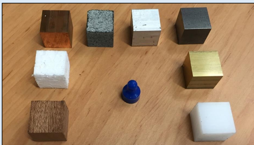
Figuur 5: De opstelling om magnetisme te testen..
