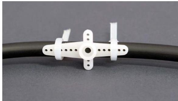
La longueur entre l'extrémité du tuyau et l'hélice est importante - le coude créé par le servo doit être suffisamment long pour arrêter l'écoulement de l'eau. Si le coude est trop petit, l'eau continuera à couler en position "arrêt" - les plantes martiennes ne survivront pas ! Pour connecter le tuyau au servo, il suffit de cliquer pour le mettre en place.
