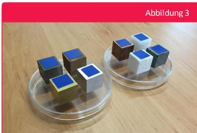
↑ Versuchsaufbau für die Wärmeleitfähigkeit
