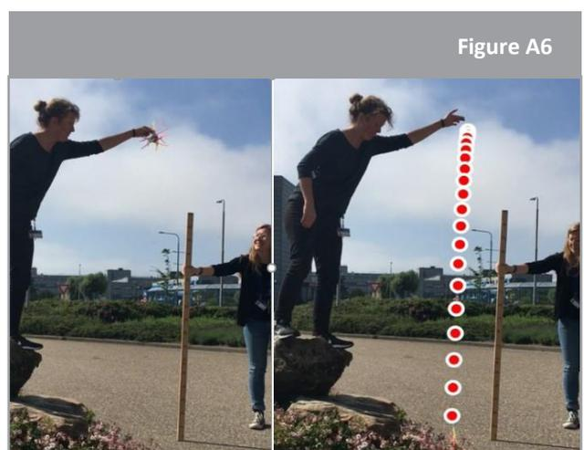
↑ Exemple d'analyse du mouvement vidéo d'une chute d'essai à partir d'une hauteur d'environ 2 m.
