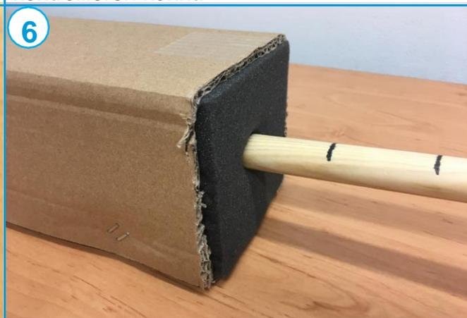
6 Schaltet die Lichtquelle ein und schiebt sie in den Kasten. Der Abstand zwischen der Lichtquelle und der Solarzelle sollte ca. 10 cm betragen. Dieser Abstand darf während des Experiments nicht verändert werden. (Nicht den Stab bewegen!).
