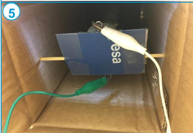
5 Befestigt die Solarzelle in dem Kasten und verbindet sie per Reihenschaltung mit einem Amperemeter und per Parallelschaltung mit einem Voltmeter (oder benutzt ein Multimeter). Schließt den Kasten.
