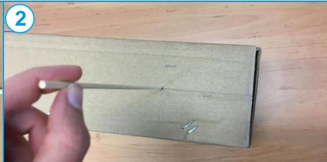
2 Benutzt den Kasten aus Übung 1. Markiert einen Punkt auf der Kastenseite, an dem der Stab durch den Kasten gehen soll. Vergewissert euch, dass er den gleichen Abstand zu der Ober- und Unterseite des Kastens hat und dass die Solarzelle genug Platz für die freie Rotation innerhalb des Kastens hat.
