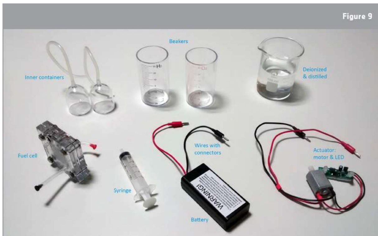
Equipement nécessaire à la construction d'un système de pile à combustible
