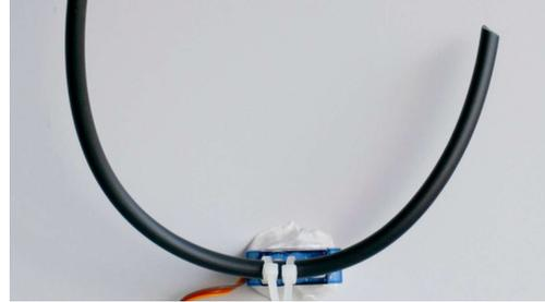
Nous sommes maintenant prêts à fixer le tuyau au servo. Il suffit de cliquer pour le mettre en place et nous sommes presque prêts !
