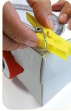
Verwendet einen Zahnstocher, um die Tiefe bis zur Mitte der Taschenlampe zu messen. Markiert den Zahnstocher und platziert die Wäscheklammer an der Markierung.
