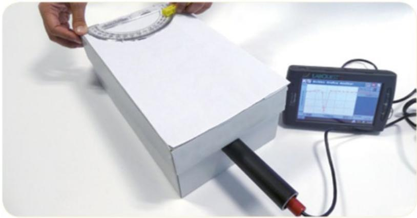
Allumez votre enregistreur de données et placez le capteur dans le trou pour prendre les mesures. Alternativement, nous pouvons placer l'enregistreur de données dans une autre boîte, sécurisée par un rabat en carton ou du ruban adhésif.
