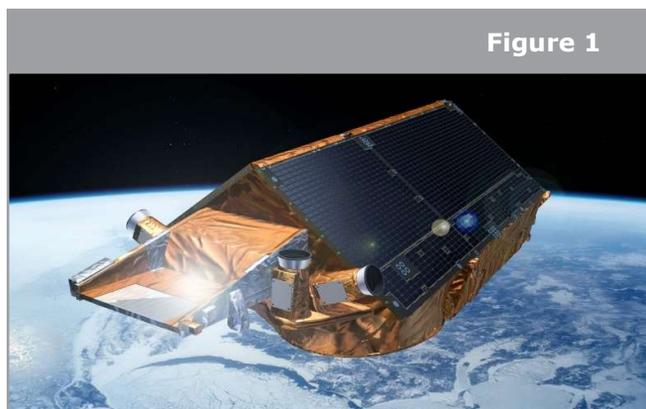
↑ Le satellite Cryosat de l'ESA est dédié à la mesure de l'épaisseur des glaces de mer polaires et à la surveillance des changements dans les calottes glaciaires qui recouvrent le Groenland et l'Antarctique.
